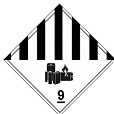
neues Kennzeichen Nr. 9A
